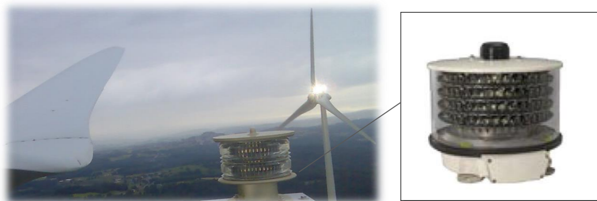
Figure 38 : Balisage d'une éolienne.
